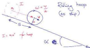
$$\begin{split} E &= T + V \\ &= \text{rotation k. e.} + \text{k.e. of c. g.} + mgs \sin \alpha \\ &= \frac{1}{2}I\omega^2 + \frac{1}{2}mv^2 + mgs \sin \alpha \\ &= \frac{1}{2}I\frac{\dot{s}^2}{a^2} + \frac{1}{2}m\dot{s}^2 + mgs \sin \alpha \\ &= \frac{1}{2}\left(\frac{I}{a^2} + m\right)\dot{s}^2 + mgs \sin \alpha \end{split}$$
